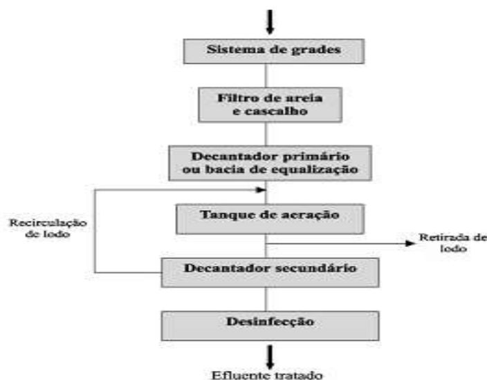
Figura 1.8 – Diagrama de blocos do tratamento de Lodo ativado Fonte: Kunz et al
