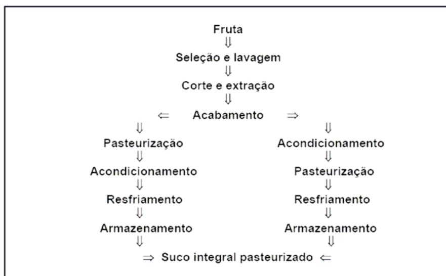
**Figura 4.8. Fluxograma do Processo de Obtenção de Suco de Fruta Integral Pasteurizado.**
