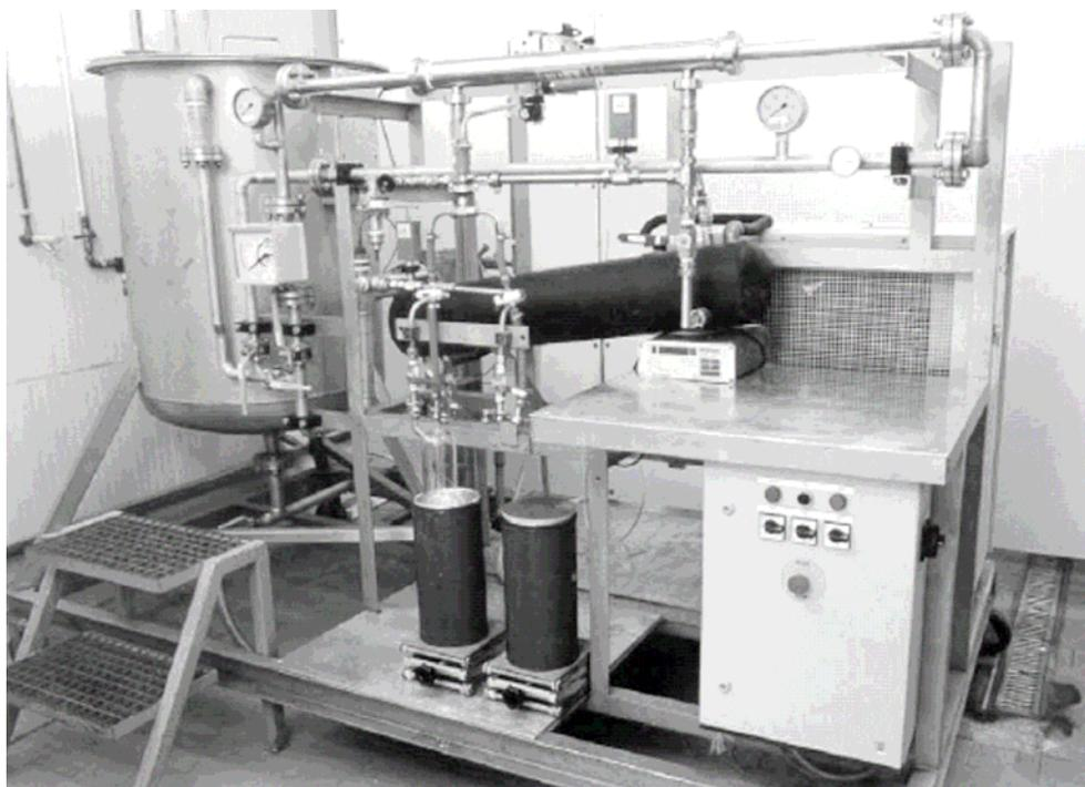
**Figura 4.12. Módulo Piloto Típico Usado no Processo de Pervaporação**
