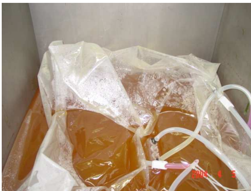
Figura 32. Bolsa Plástica Estéril em Operação no Interior de um Tanque.
