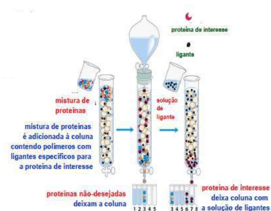
Figura 25. Esquema de Cromatografia de Afinidade. [37]
