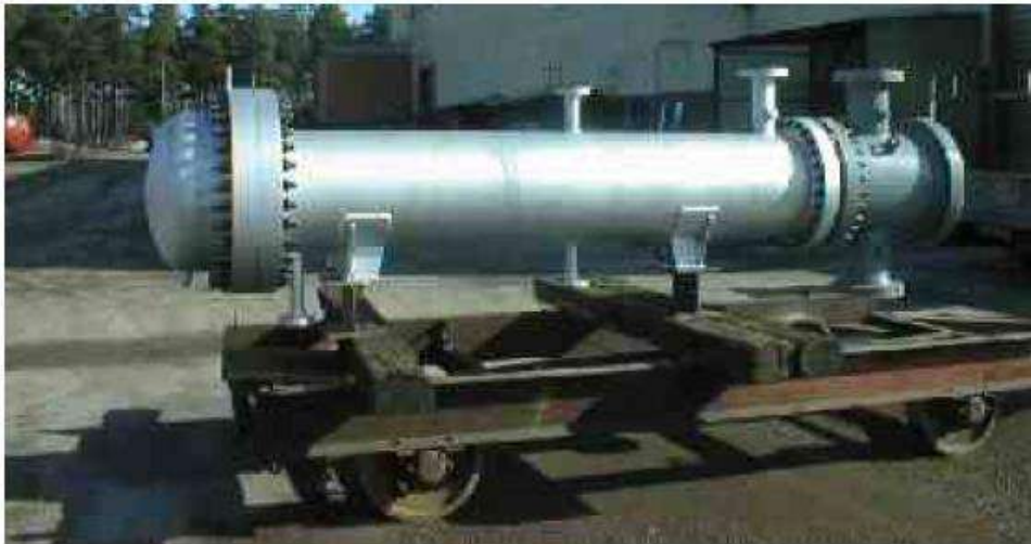
Figura 3.4 Trocador após Montagem
