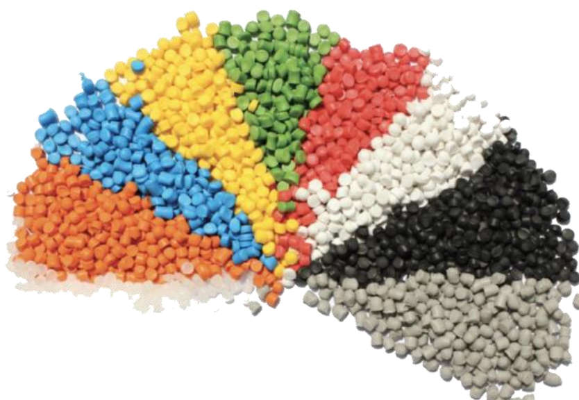
Figura 27 - Pellets de ABS
