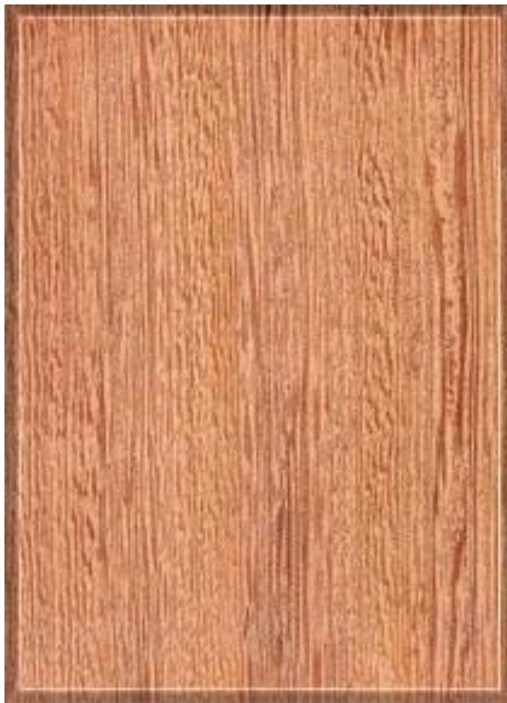
Figura 59 - Face Radial do Argelim – Fonte: IPT
