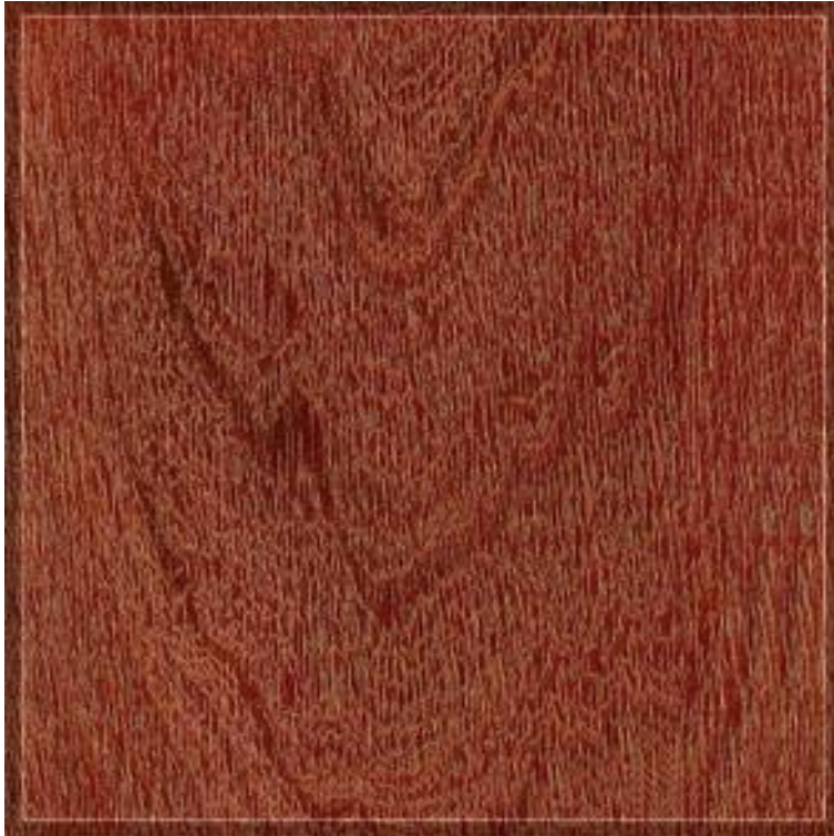
Figura 56 - Face Tangencial da Maçaranduba – Fonte: IPT
