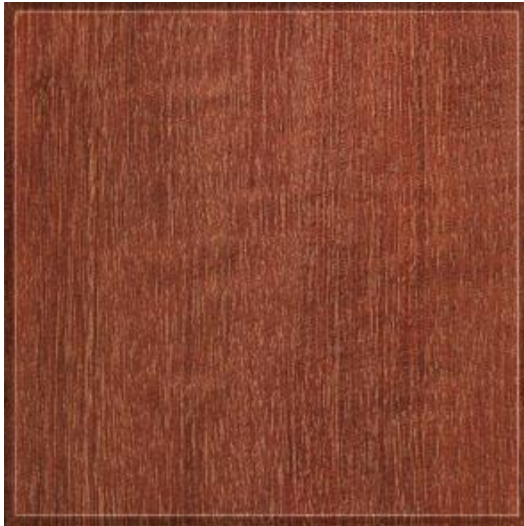
Figura 55 - Face Radial da Maçaranduba – Fonte: IPT
