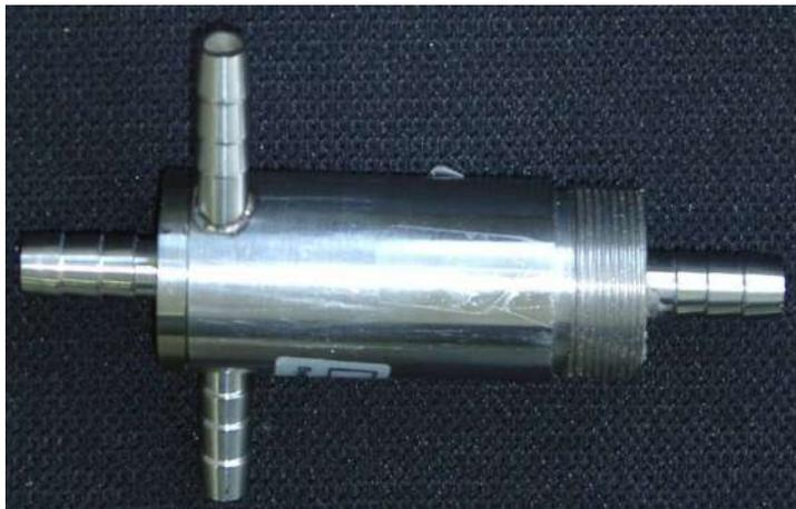
Figura 1.1 - Foto do hidrociclone utilizado como base para o presente trabalho
