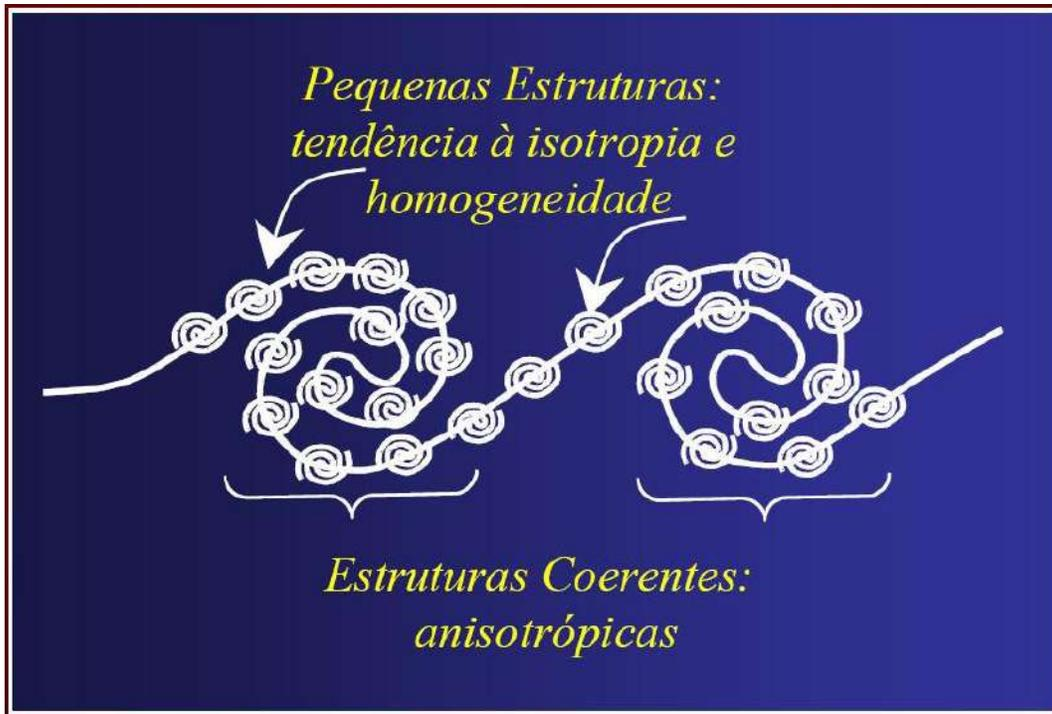
Figura 3.2– Estruturas turbulentas (NETO, A. S., LTCM-UFU).
