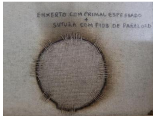
Figura 26: Enxerto confeccionado com tecido de linho. Verso da tela onde pode-se observar a adição de fios de paraloid 34 para finalização do procedimento. Fonte: Caroline Leal
