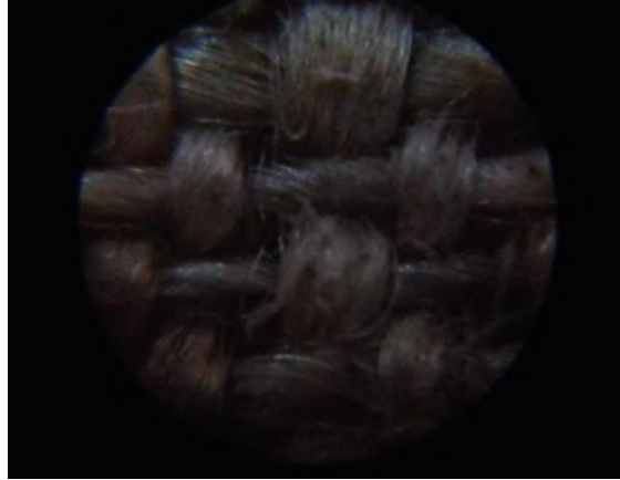
Figura 36: Fragmento de linho com goma a partir de uma visão microscópica, que mostra sua estrutura de tramas e urdiduras. Nota-se que, diferente do linho sem goma, esse apresenta uma trama um pouco mais espaçada e desfiada.
