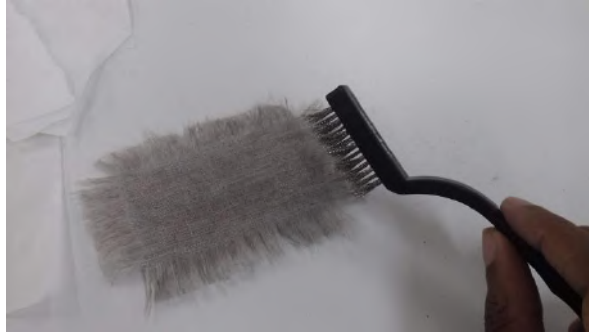
Figura 23: Confecção de remendo com tecido de linho. Fonte: Caroline Leal
