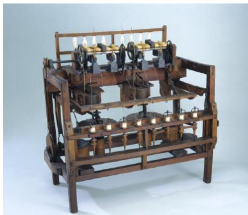
Figura 12: Walter Frame criada por Richard Arkwright em 1775. Conseguiu produzir fios mais resistentes que a Spinning Jenny . Fonte: collection.sciencemuseumgroup.org.uk/objects/co44832/arkwrights-walter-frame-1775-spinning-machine .
