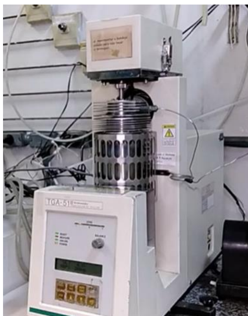
Figura 33: Imagem de uma termobalança TGA-51 da marca Shimadzu. Essa termobalança foi utilizada para realização das análises termogravimétricas das amostras de tecidos durante o estudo. Fonte: Prof. Dr. Jivaldo do Rosário Matos.
