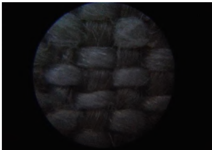
Figura 35: Imagem do fragmento de linho sem goma a partir de uma visão microscópica, em que mostra sua estrutura de tramas e urdiduras.
