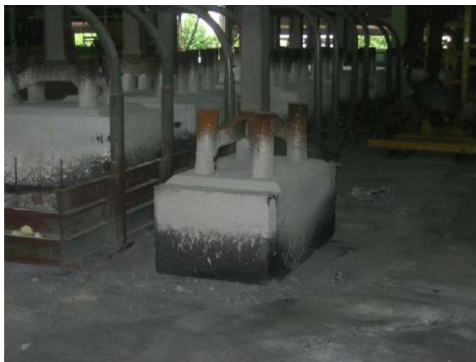
Figura 2: Anodo pré-cozido de coque de petróleo e piche
