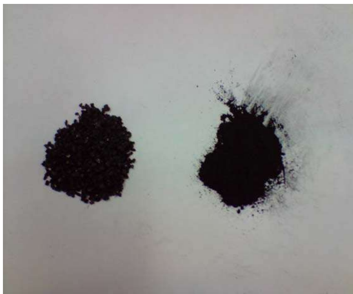
Figura III. 3 – Carvão ativado granular e em pó utilizados no presente trabalho
