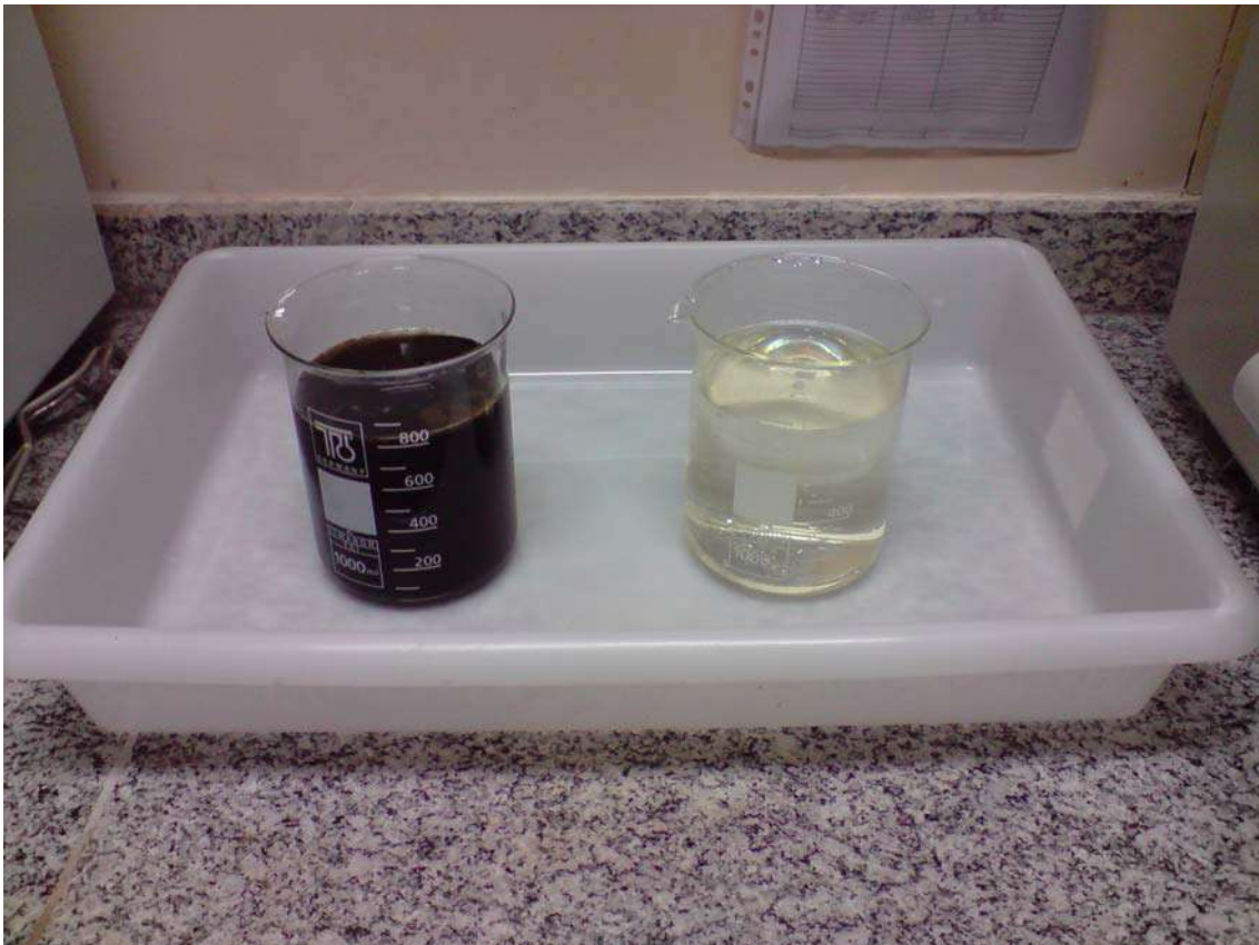
Figura IV. 8 – Foto comparativa entre lixiviado bruto e lixiviado após tratamento com lodo ativado e CAP a 10g/L
