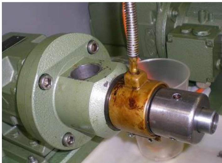
Figura 6.9 - Prensa contínua com uso de resistência para aquecimento.
