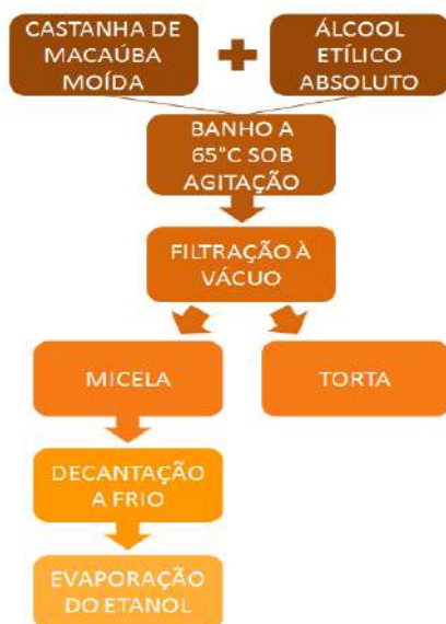
Figura 6.10 - Diagrama de blocos contendo as principais etapas de obtenção do óleo da castanha da macaúba com etanol.
