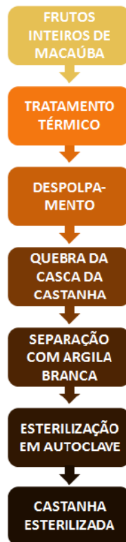
Figura 6.3 - Diagrama de blocos do pré-tratamento da castanha da macaúba.
