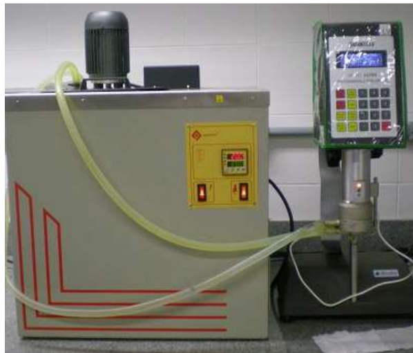
Figura 6.13 - Reômetro de placas utilizado na análise de viscosidade.
