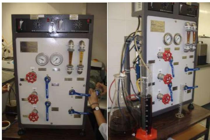
**Figura 4.4. Módulo de membranas utilizado durante os experimentos de hidrólise enzimática do bagaço de cana pré-tratado termicamente a vapor.**
