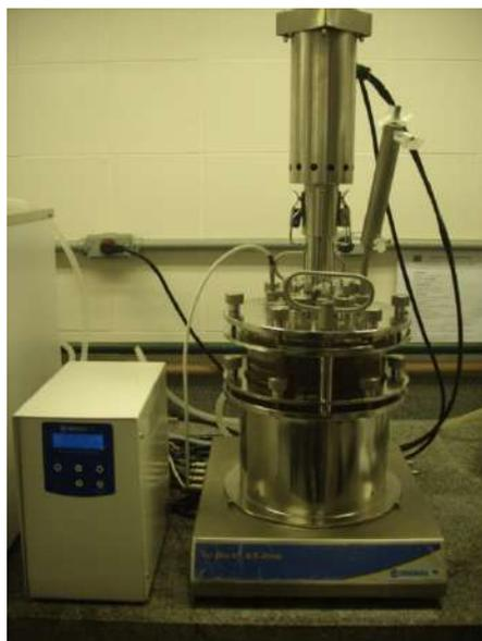
**Figura 4.3. Vaso de mistura com agitador do tipo turbina e volume útil de 4,5L.**
