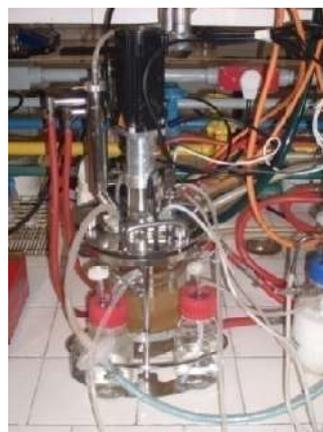
**Figura 4.1. Produção de enzimas celulolíticas em fermentador utilizando a cepa de *T.reesei* Rut C30.**
