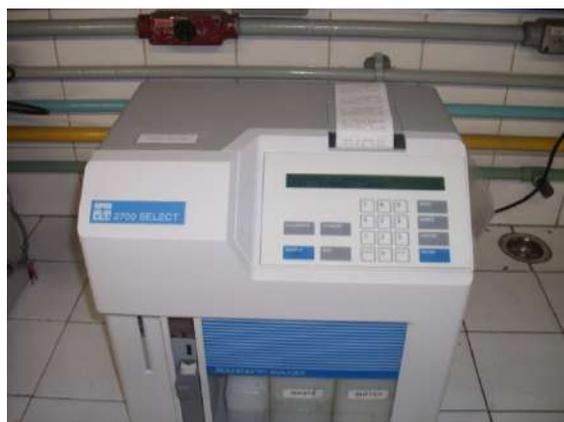
**Figura 4.2. Equipamento YSI 2700, utilizado para quantificação de glicose nas amostras obtidas durante os testes de hidrólise enzimática e também para a quantificação da atividade enzimática de  $\beta$ -glicosidases.**
