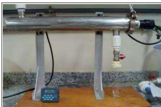
**Figura IV.3** - Aparato para reação com radiação Ultravioleta: Foto-Fenton
