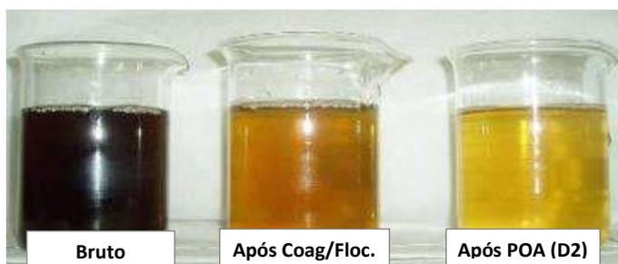
**Figura V.8** - Aspecto visual das amostras: lixiviado bruto; após coagulação/floculação; e após o ensaio **D2** (1500 mg/L de  $H_2O_2$ ) de POA.
