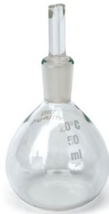
Figura 4.8 – Picnômetro usado para determinação da densidade do bagaço.
