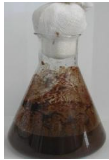
Figura 4.4 – Erlenmeyer contendo 100g/l de bagaço de cana e 10 FPU/g de bagaço e BGU ( \beta -glucosidase) na relação 1:1.
