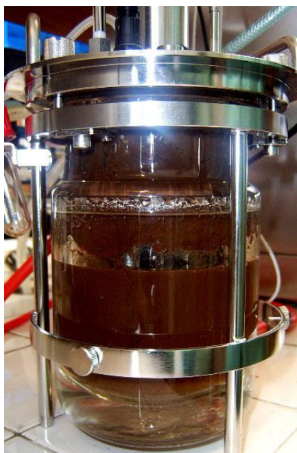
Figura 4.7– Reator utilizado para hidrólise enzimática do bagaço de cana.
