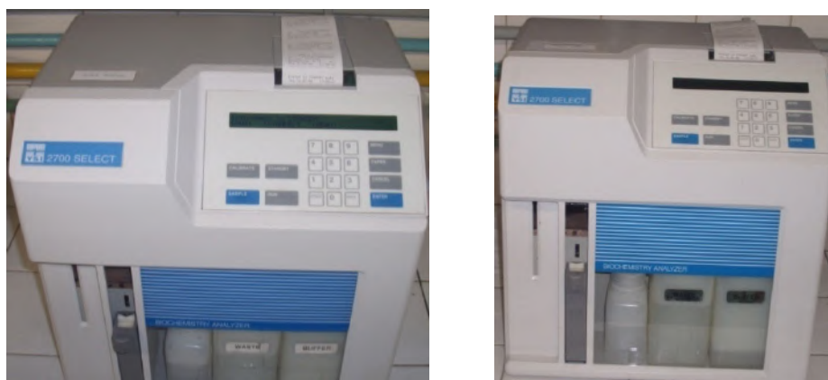
Figura 4.5 – Bioanalisador utilizado na dosagem de glicose.
