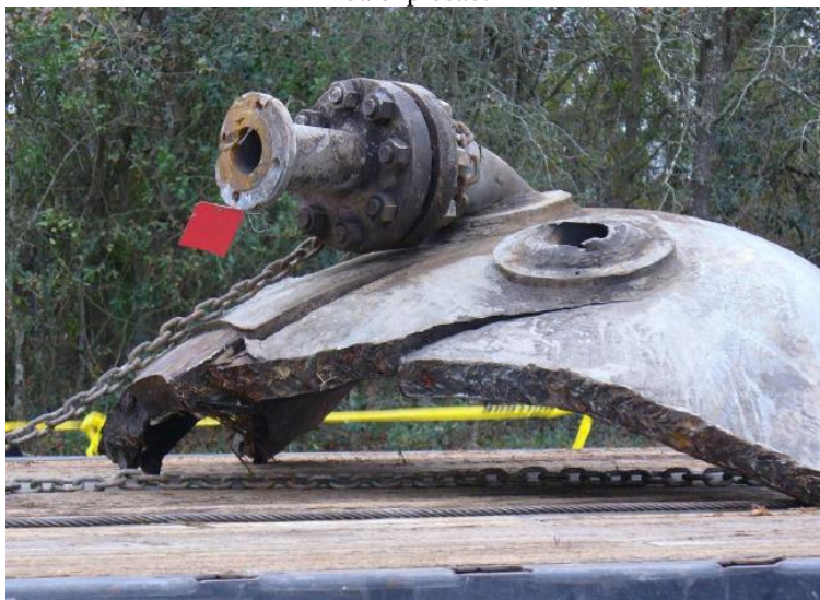
Figura 29: Destroços do topo do reator encontrado nas redondezas próximo à planta da T2 Lab após a ocorrência da explosão.
