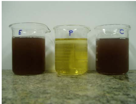
Figura IV.16 – Fotografia das amostras de Alimentação (E), Permeado (P) e Concentrado (C) da ultrafiltração
