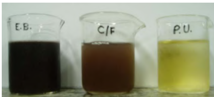
Figura IV.19 – Fotografia das amostras de Efluente Bruto (E.B.), Sobrenadante da coagulação/floculação (C/F) e permeado da ultrafiltração (P.U.)
