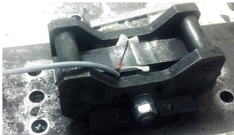
Figura 25: Amostra recebendo carga para primeiro ensaio de corrosão sob tensão
