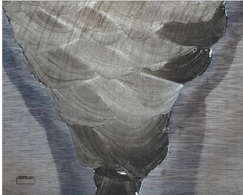
Figura 19: Macrografia da amostra após os ataques para revelar a microestrutura do metal de base e do metal de solda
