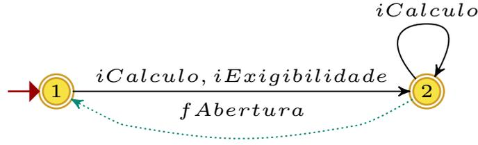
Figura 4.9: Autômato  $H_{a1}$  que modela a especificação referente ao processo de Exigibilidade.
