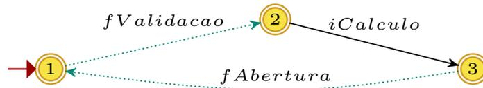
Figura 4.6: Autômato  $H_{f8}$  que modela a especificação referente ao processo de Apuração de Cota.
