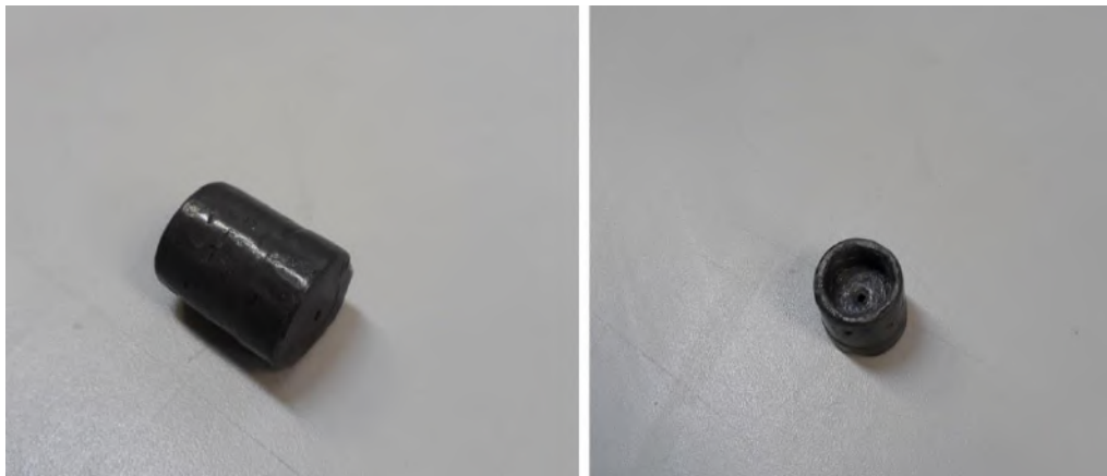
Figura 3.5: Colimador de chumbo (AUTOR, 2019).
