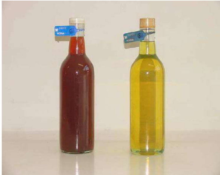
Figura II.1: Hidrotratamento de diesel NA U-110 – carga e produto
