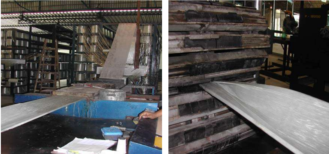
Figura 6.1 – Etapas do processo de pultrusão.
