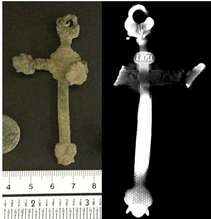
Figura 29 - Comparação da amostra original com a amostra obtida por microtomografia. A esquerda a imagem original da amostra e a direita uma vista coronal bidimensional. Nota-se que a escrita pode ser vista nitidamente na vista bidimensional, e na foto original a escrita é vista com bastante dificuldade.
