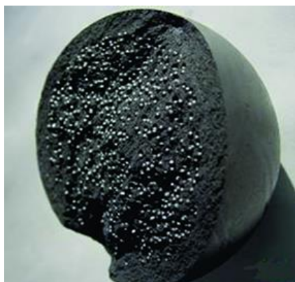
Figura 6 – Combustível esférico aberto onde é possível se observar as microsferas. (THORIUM100)
