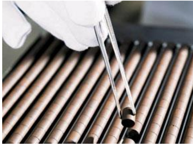
Figura 3 – O dióxido de Urânio com formato cilíndrico sólido. (BUYS, 2009)
