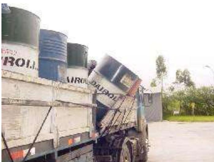
*Figura 5* – Transporte inadequado – Risco de Queda
