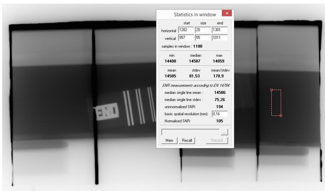
Figura 42: Método de cálculo da SNR_N utilizando o software “iSee!” com ROI de 20 x 55 pixels
