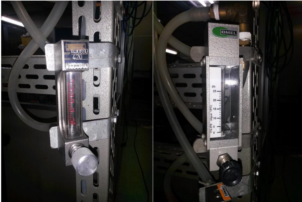
Figura 4.7: Rotômetros utilizados no secundário do trocador de calor (Conaut 420 na esquerda, OMEL OM 0440 P1 na direita).
