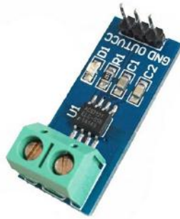
Figura 3.7: Modelo do sensor Hall utilizado no projeto.
