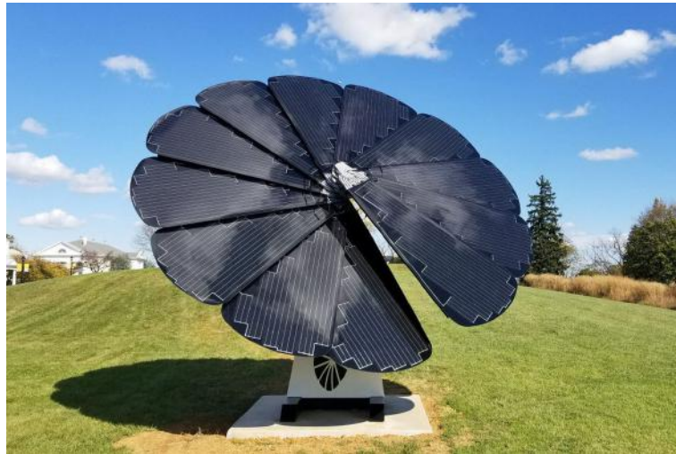
Figura 2.14: Exemplo de rastreador biaxial [9].
