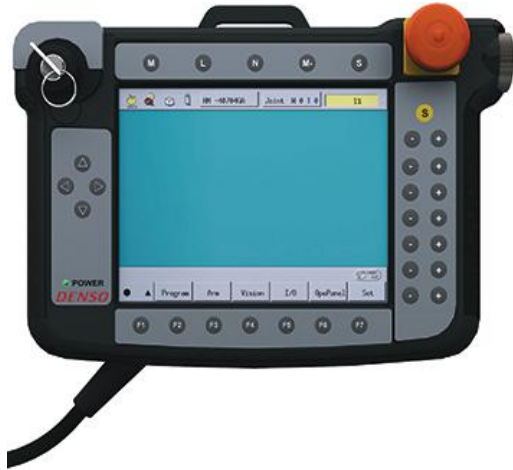
Figura 3.8: Teach pendant utilizado para operar o braço robótico.
