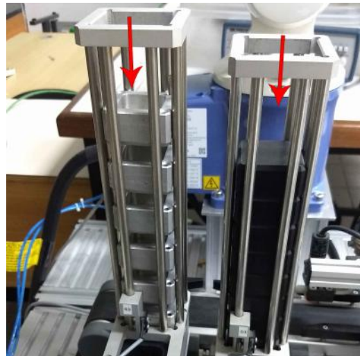
(d) Peças separadas são armazenadas nas respectivas torres pelo braço robótico.
