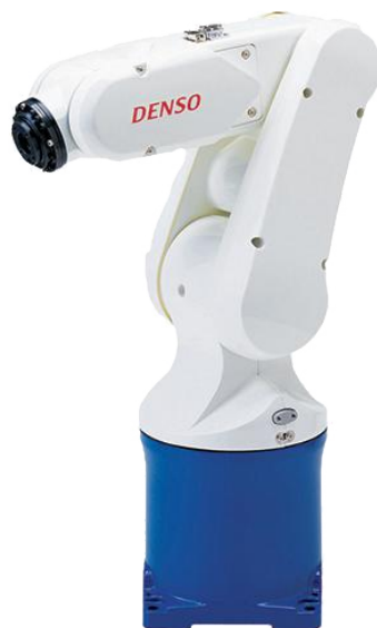
Figura 3.1: Braço robótico VP-6242M de 6 eixos do fabricante DENSO [1].
