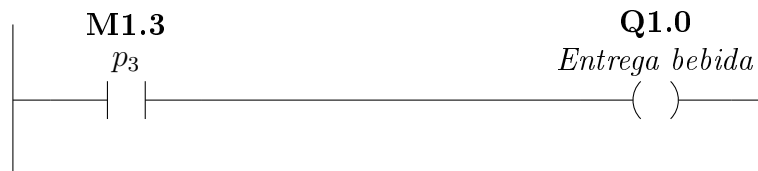
Figura 2.25: Lógica Ladder do módulo de ações da rede de Petri do exemplo da máquina de bebidas.
