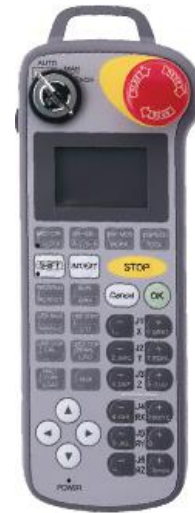
Figura 3.9: Mini pendant utilizado para operar o braço robótico.
