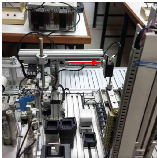
(e) Braço pneumático gira para o lado do elevador e estende o atuador horizontal.
