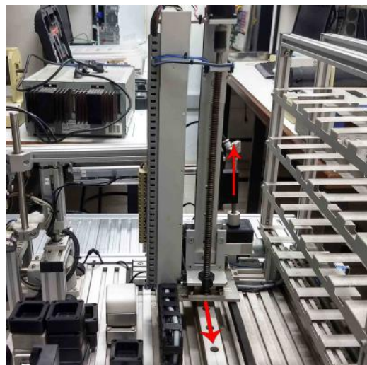
(f) Braço pneumático pega o bloco e elevador vai para posição inicial.
