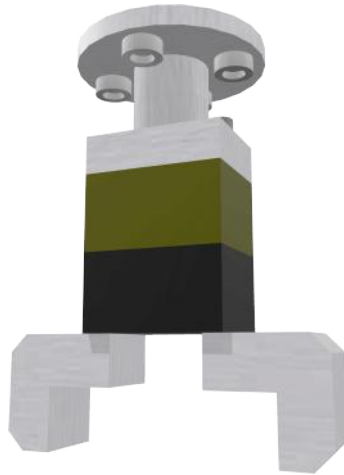
Figura 3.5: Extensão do tipo garra pneumática instalada no braço robótico.
