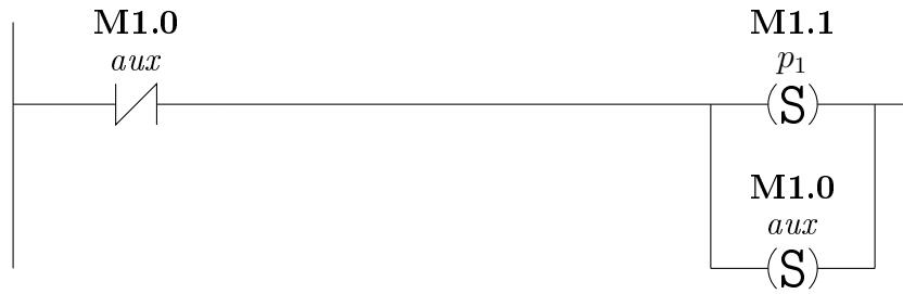
Figura 2.24: Lógica Ladder do módulo de inicialização do exemplo da máquina de bebidas.
