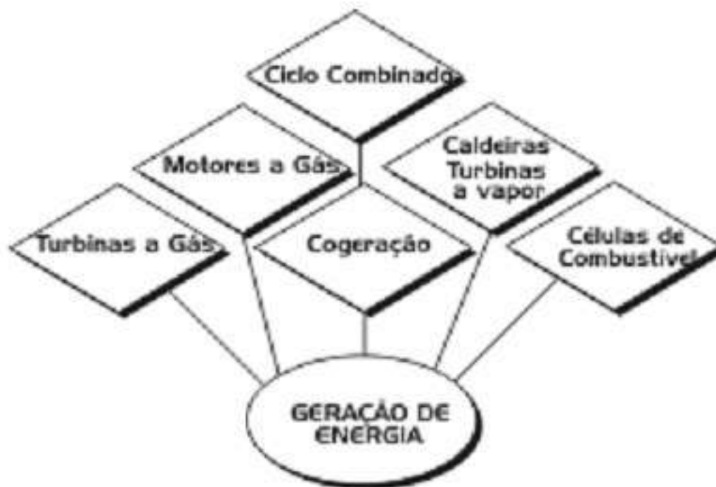
Figura 9. Elo de produtos finais para geração de energia a partir do Gás Natural Fonte: ALONSO (1999)
