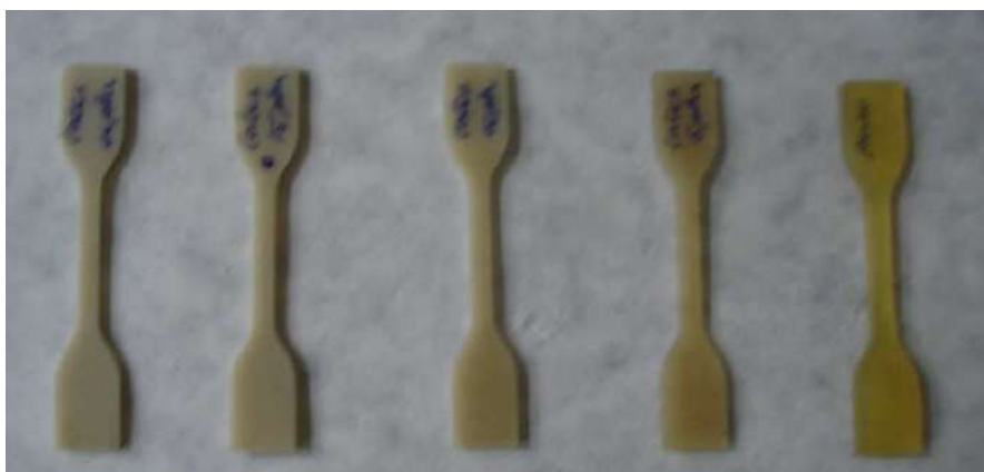
Figura XIII.2 - Corpos de prova do TPU puro e dos compósitos TPU + carbonato de cálcio.
