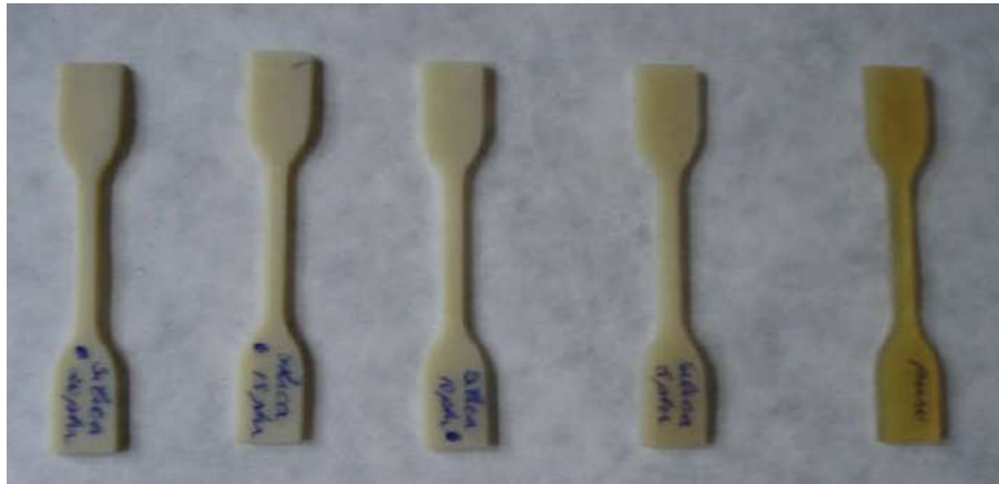
Figura XIII.3 - Corpos de prova do TPU puro e dos compósitos TPU + sílica.
