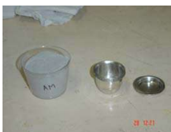
Figura 6.8 – Fotos da amostra moída e ao lado o cadinho de platina/ouro.
