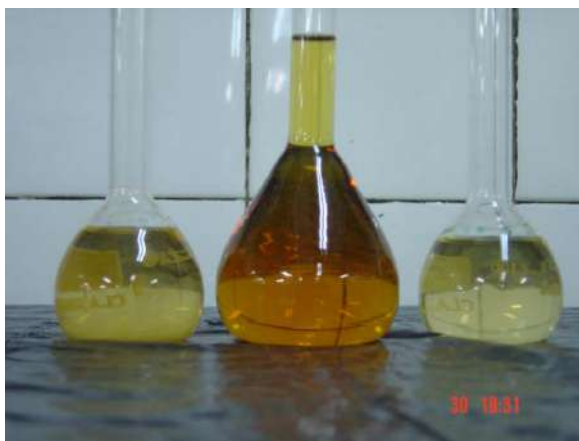
Figura 7.2 – Resultados do ensaio de determinação colorimétrica do teor de matéria orgânica: o balão da esquerda contém uma solução com matéria orgânica extraída da areia amarela; o frasco à direita contém outra solução com extrato orgânico, obtido da areia branca; o do centro mostra a cor da solução padrão.
