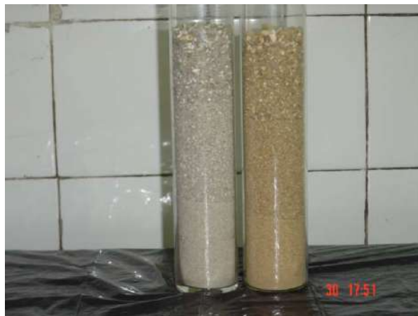
Figura 7.6 – Frações granulométricas das areias branca e amarela, dispostas numa proveta na ordem crescente de tamanho de grão de baixo para cima
