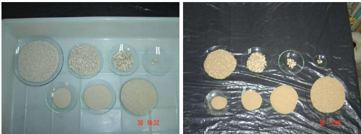
Figura 7.5 – Visão aproximada das frações granulométricas da areia branca e amarela, separadas nos ensaios para determinação granulométrica utilizando a série normal de peneiras.
