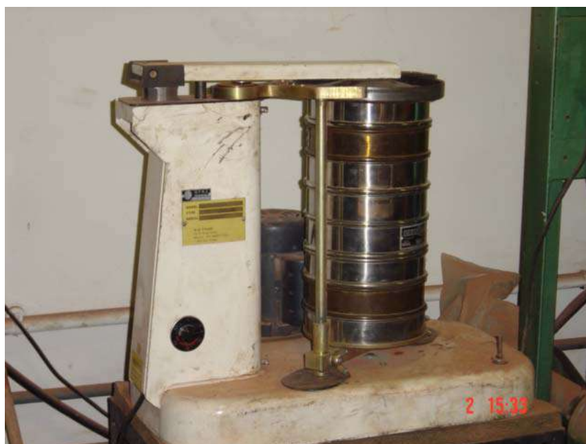
Figura 6.4 – Fotos do peneirador RO-TAP do Laboratório de Tecnologia Mineral.
