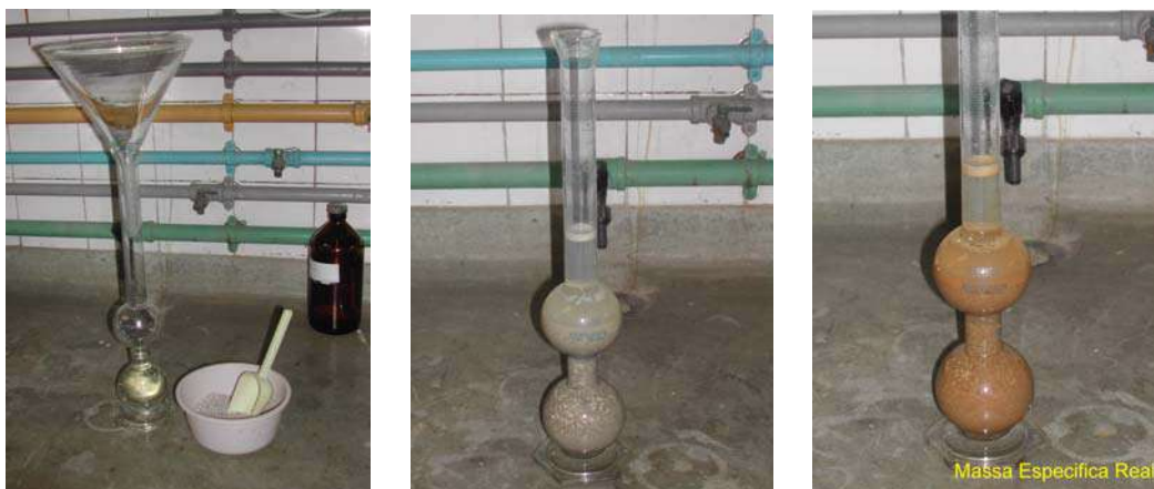
Figura 7.1 – Fotos das etapas inicial (à esquerda) e final das análises para determinação da massa específica real das amostras de areia branca (ao centro) e amarela (à direita).
