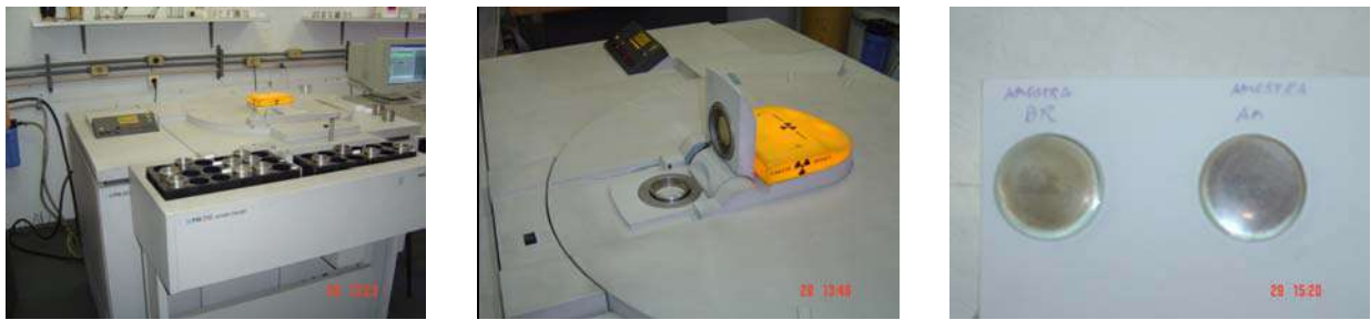
Figura 6.10 – Fotos do Espectrômetro de Fluorescência de raio-X (à esquerda: vista frontal, e ao centro: vista superior – compartimento para a pastilha aberto). À direita, foto das pastilhas fundidas escurecidas após a análise no FRX.
