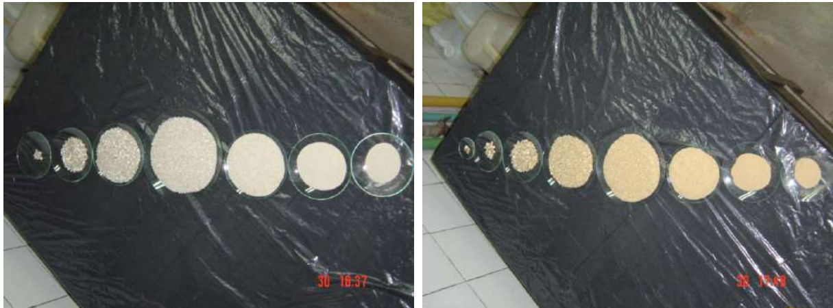
Figura 7.4 – Frações Granulométricas das areias branca e amarela, separadas nos ensaios para determinação granulométrica utilizando a série normal de peneiras, dispostos em ordem decrescente de tamanho de grão da esquerda para direita.
