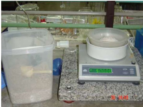
Figura 6.3 – Fotos da balança e do peneirador vibratório, usados nos ensaios da série normal de peneiras.
