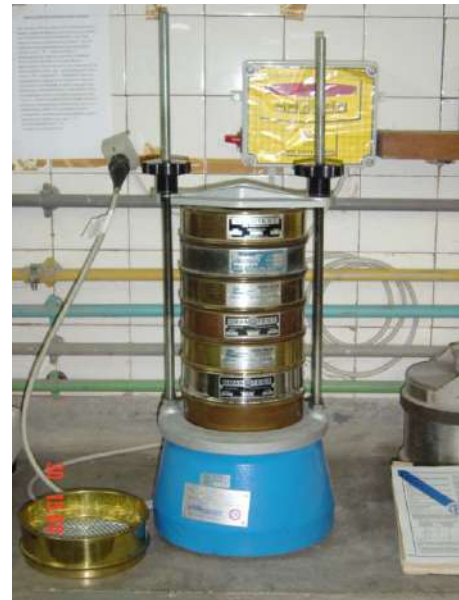
Figura 6.3 – Fotos da balança e do peneirador vibratório, usados nos ensaios da série normal de peneiras.
