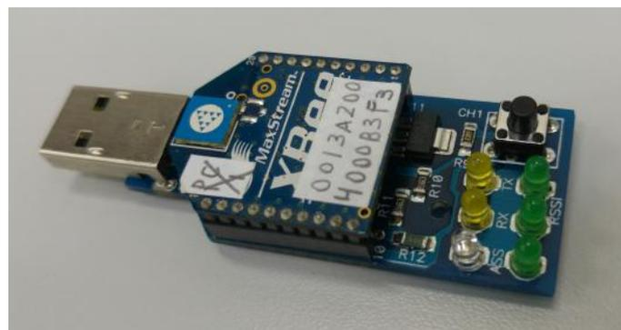
Figura 4.11: *Dongle* com módulo XBee usado na captura de dados transmitidos pelo FCAM.
