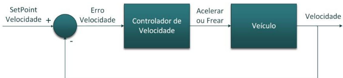
Figura 4.3: Diagrama de blocos para o Cruise Control.
