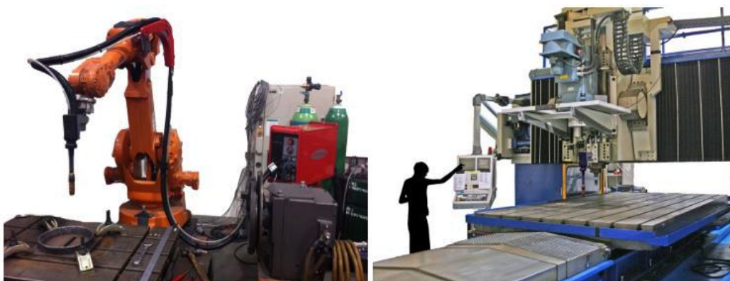
Figura 2 - Equipamentos para fabricação por WAAM, adaptado de (MARTINA, Filomeno, WILLIAMS, 2015)
