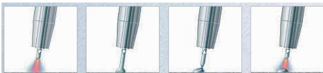
Figura 3 - Representação do funcionamento de CMT, adaptado de (ROD, IP, et al. , 2005)
