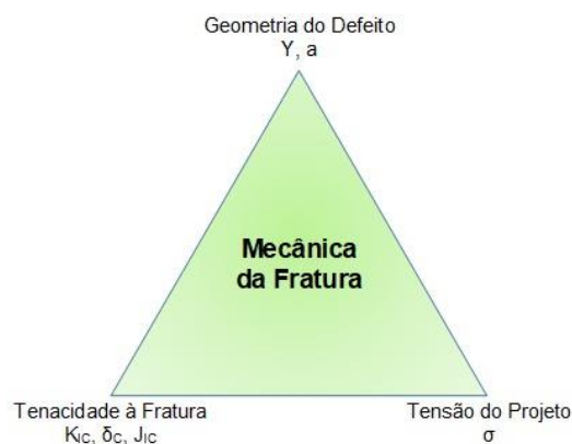
Figura 2.1 - Interdependência das variáveis da mecânica da fratura que correlaciona a geometria e o tamanho do defeito ( Y, a ), a tensão aplicada no componente ( \sigma ) e a tenacidade à fratura do material ( K_{Ic}, \delta_c, J_{Ic} ).
