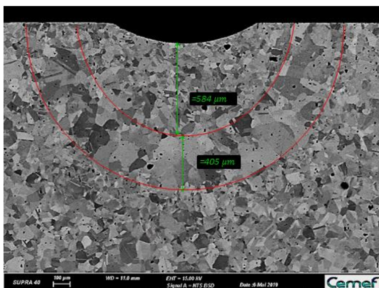
Figura 20: Evolução microestrutural do corpo de prova indentado após ter sido submetido ao tratamento térmico 1000°C/1h [ \Delta_{centro} \leq 100 ].
