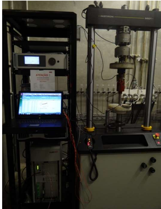
Figura 10: Fotografia da máquina Instron 8801 utilizada nos ensaios.
