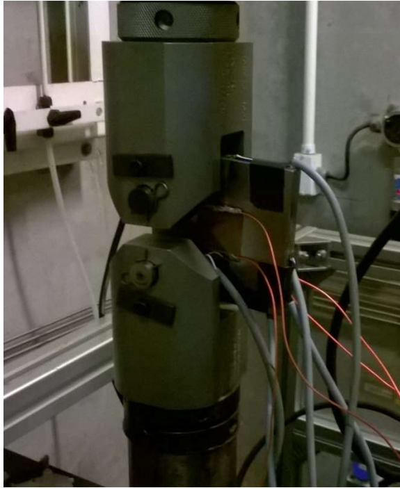
Figura 13: Ensaio de propagação da pré-trinca no corpo de prova CT em aço X65.
