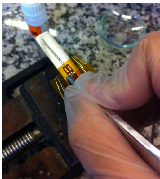
Figura 14: Foto da colagem do strain gauge na face oposta à trinca no corpo de prova CT.
