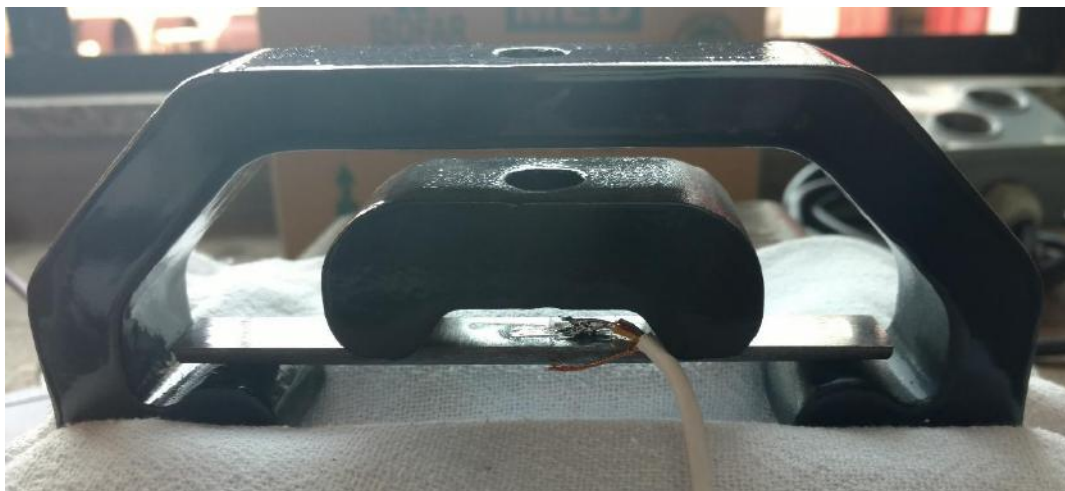
Figura 22 Posicionamento do corpo de prova na garra de flexão
