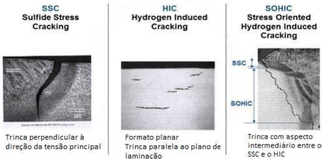
Figura 14 Morfologia das trincas formadas pelos mecanismos de fragilização por hidrogênio – adaptado [44]
