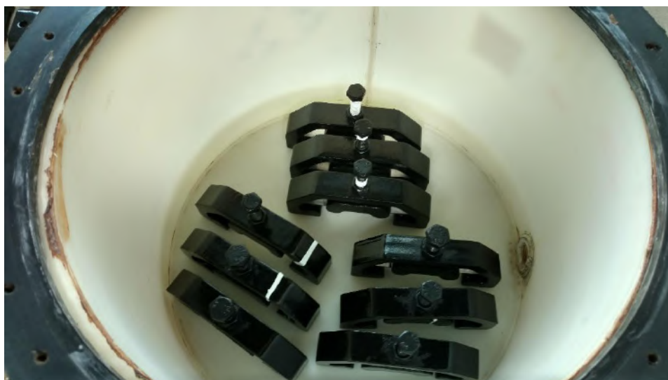
Figura 25 Garras posicionadas dentro da cuba para o ensaio 1
