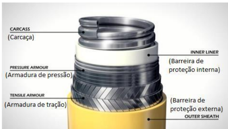
Figura 1 Composição geral de um duto flexível [9]
