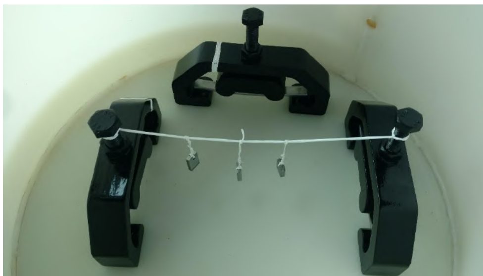
Figura 26 Montagem das garras e dos corpos de prova para perda de massa no ensaio 2
