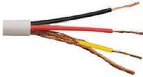
Figura 19 Configuração esperada após desencapar os fios
