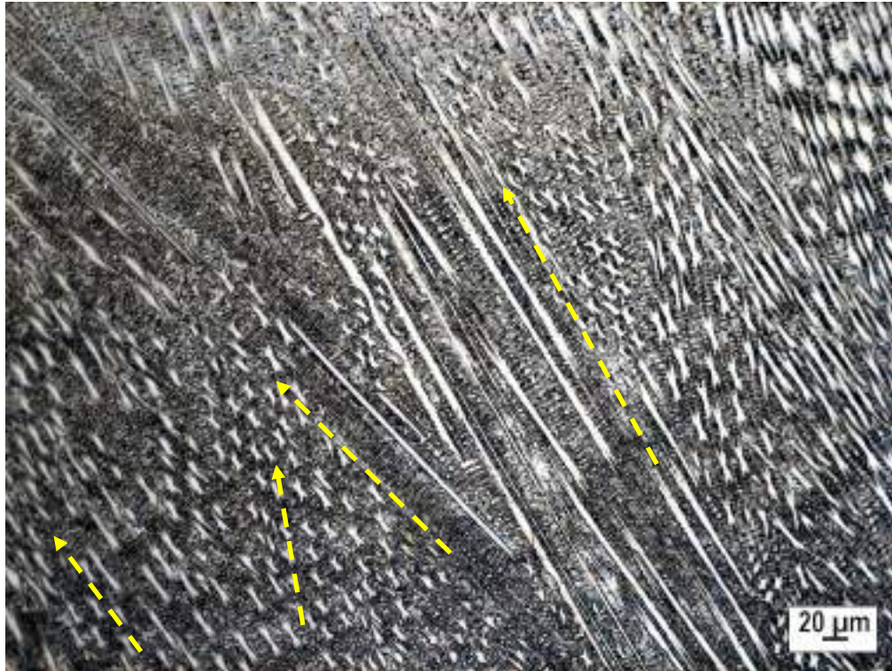
Figura 45: Orientação do crescimento dos grãos do revestimento pelo processo GTAW
