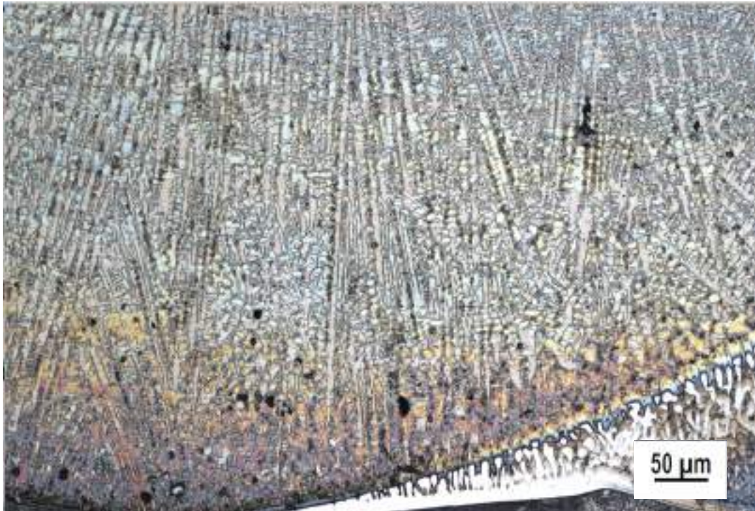
Figura 46: Orientação do crescimento dos grãos do revestimento feito pelo processo PPTAW.
