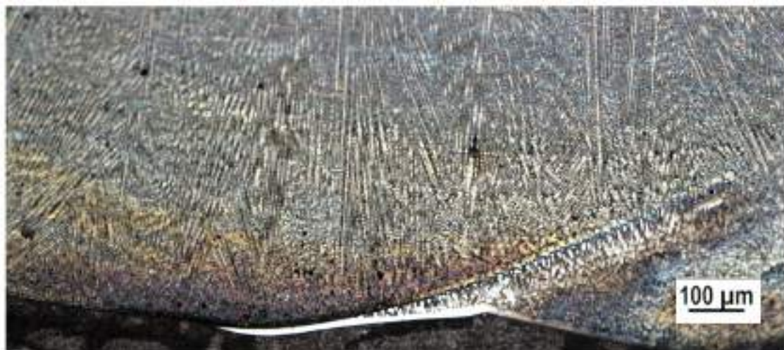
Figura 47: Formação de macrosegregação na zona de transição no processo de PPTAW.
