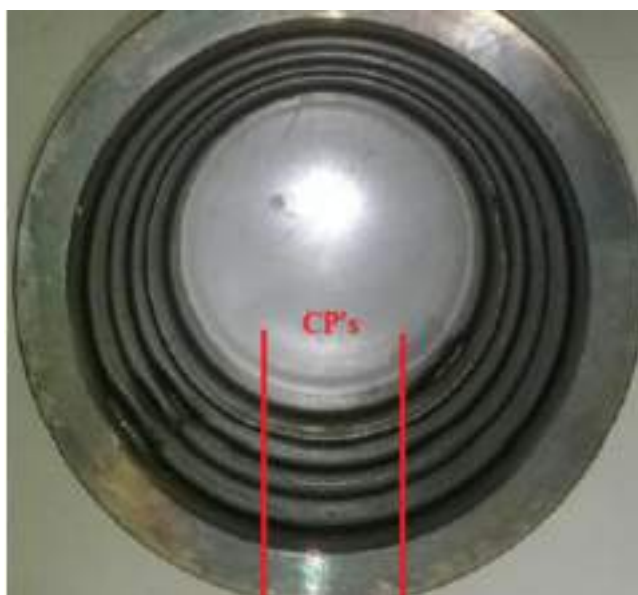
Figura 22: Corte transversal para a retirada da amostra para análise
