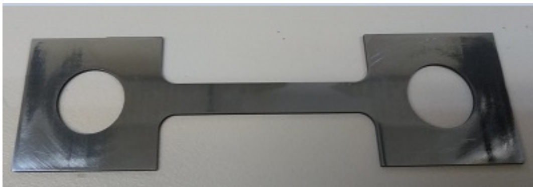
Figura 7: Corpo de prova de tração com largura de 6 mm, comprimento de 34 mm e espessura de 1 mm, aproximadamente.
