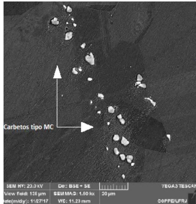
Figura 13: MEV da liga 725 solubilizada com carbeto destacados (Aumento: 1500x)
