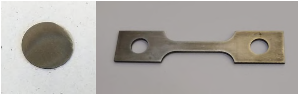
Figura 15 - Corpos de prova de ensaio de permeação (esquerda) e de ensaio de tração (direita).
