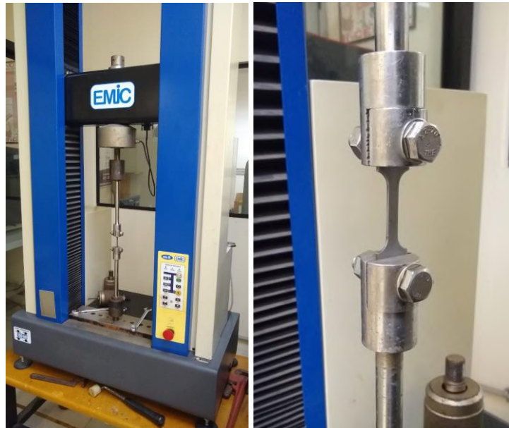
Figura 18 – Máquina de tração utilizada e corpo de prova montado antes de ser ensaiado.
