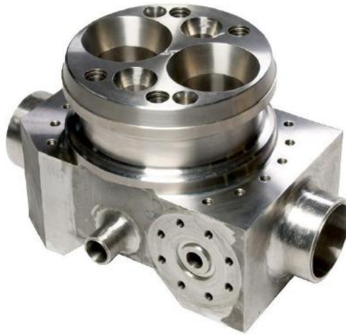
Figura 4 – Peça produzida por HIP seguida de acabamento superficial [14].
