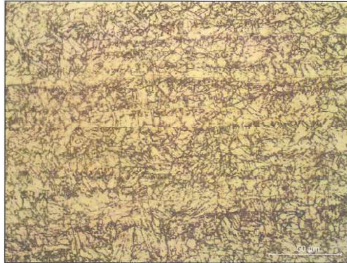
Figura 2.6: Microestrutura do aço 9Ni como recebido. Adaptado de [30].
