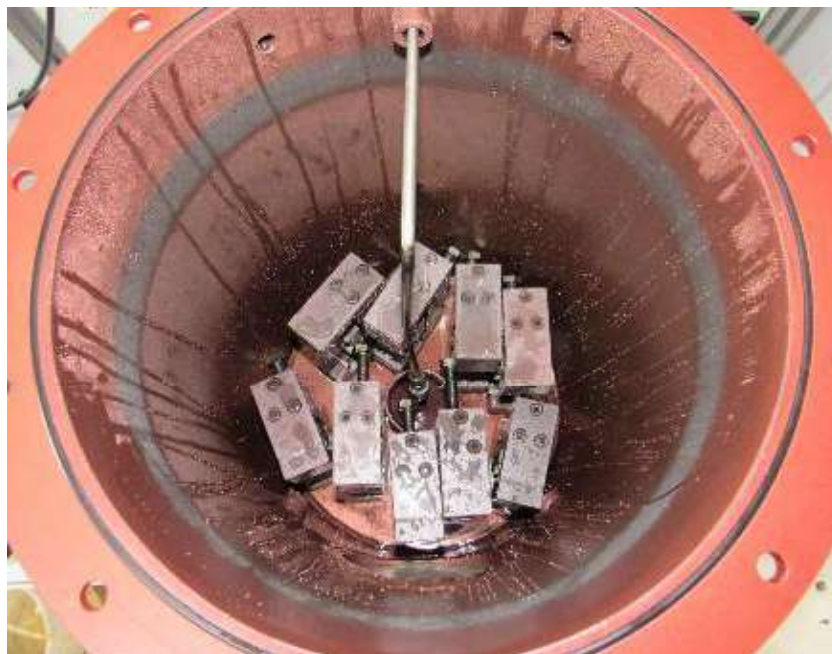
Figura 3.6: Foto dos corpos de prova posicionados dentro da célula de teste (relatório 4-point sourtec)
