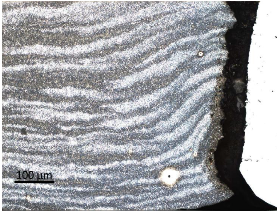
Figura 4.10: Micrografia da amostra 74/18-9 realçando trinca na linha de fusão, com aumento de 200x
