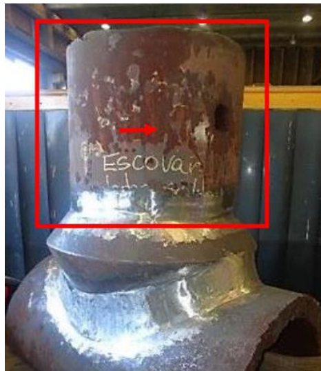
Figura 3.1.1 - Foto do coletor de saída do superaquecedor de vapor recebido com a marcação da posição de retirada dos corpos de prova. Adaptado de SANTOS (2017).
