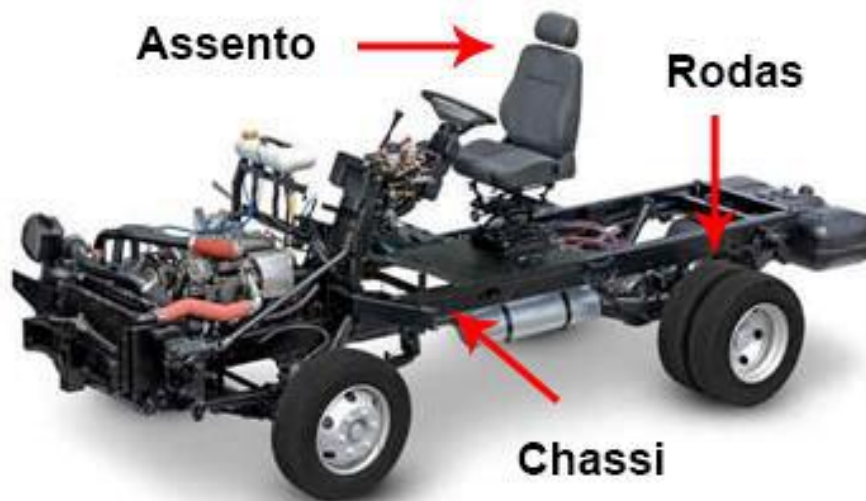
Figura 4: Componentes conectados ao chassi de um automóvel (Adaptado de [10]).
