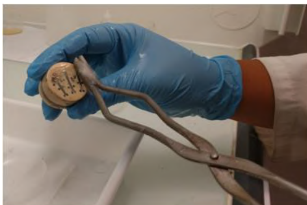
Figura 52: Ataque químico das amostras com solução Behara.
