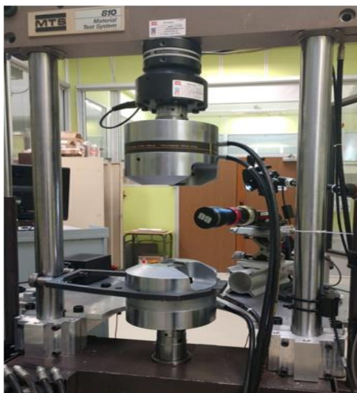
Figura 43: MTS 10T utilizada para realização dos ensaios de tração.
