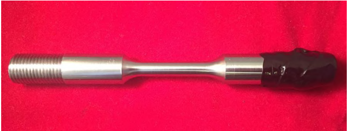
Figura 18 – Corpo de prova preparado para niquelamento eletrolítico.
