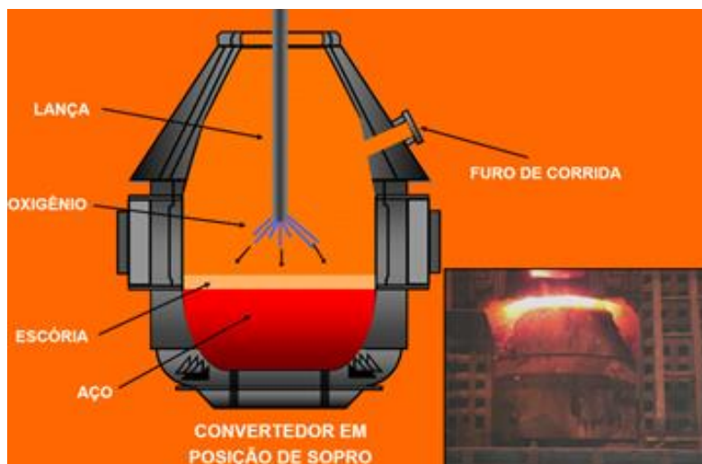
Figura 4 - Esquema de um convertedor LD. Fonte: adaptado de CONVERTEDOR LD (2015)
