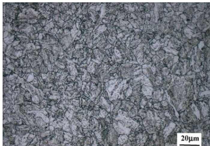
Figura 4: Micrografia óptica de aço 9Ni temperado e revenido (Adaptado de [13]).
