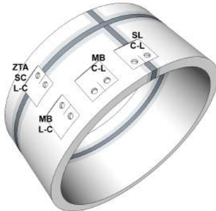
Figura 23: Esquema da direção em que as amostras foram usinadas.
