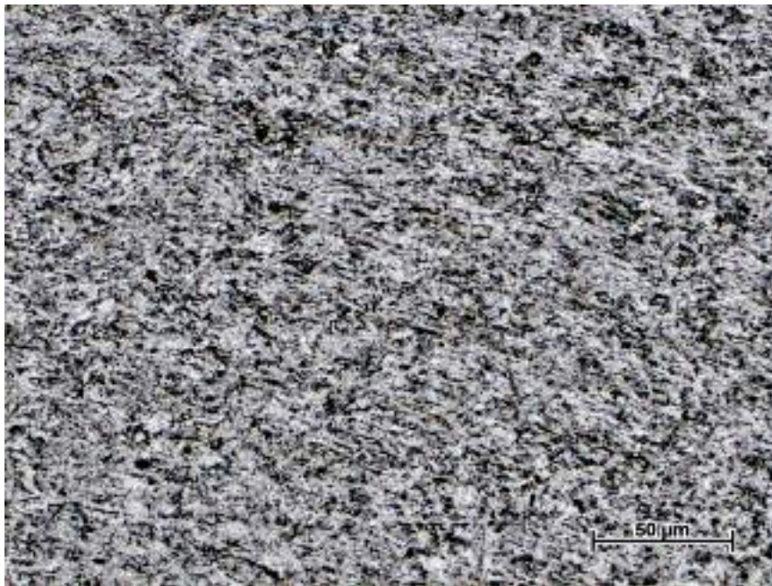
Figura 32: Micrografia da ZTA da solda circunferencial com aumento de 500x em sentido longitudinal ao crescimento de trinca.
