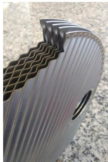
Figura 19: (a) pilha após os cortes por eletroerosão por penetração a fio e (b) pilha formada por duas placas individuais e três pares de placas soldadas.
