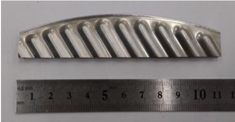
Figura 20: Corpo de prova cortado por eletroerosão de uma placa trocadora de calor.
