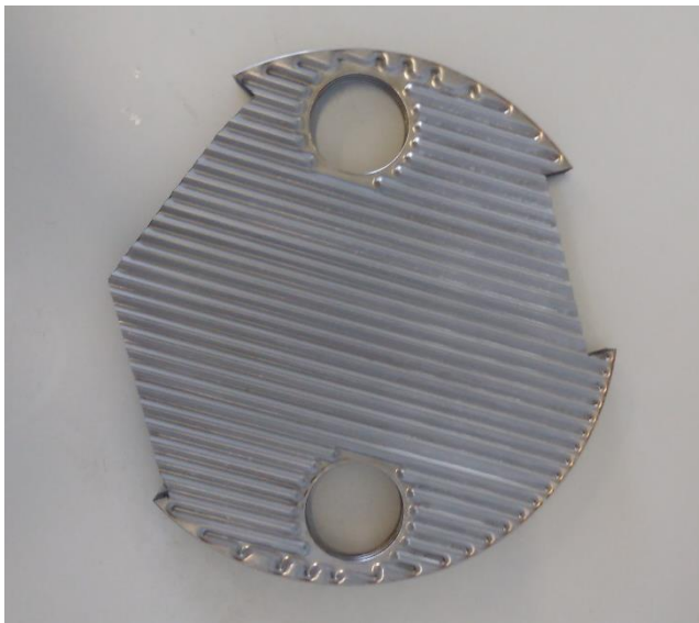
Figura 19: (a) pilha após os cortes por eletroerosão por penetração a fio e (b) pilha formada por duas placas individuais e três pares de placas soldadas.
