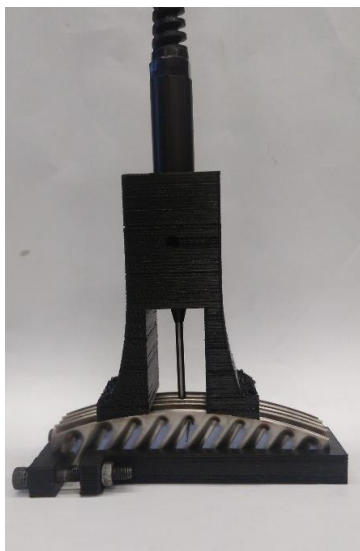
Figura 36: Montagem utilizada nos ensaios por correntes parasitas.
