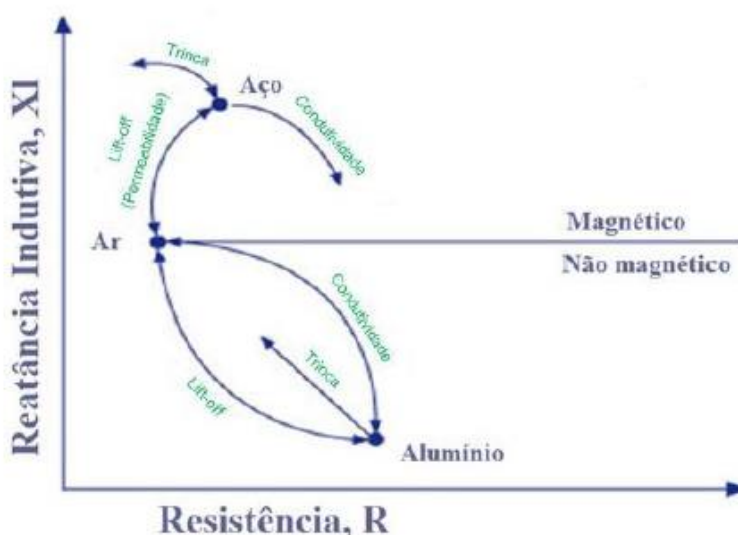
Figura 4: Plano de impedância resultante da inspeção por correntes parasitas (NDT Resource Center) (adaptado).
