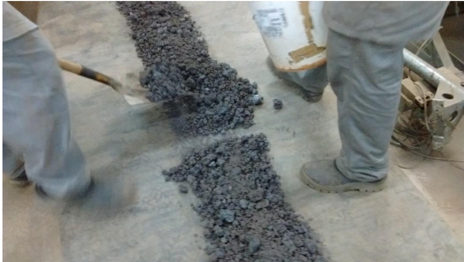
Figura 4.4. Preparação das amostras de sínter para análise granulométrica
