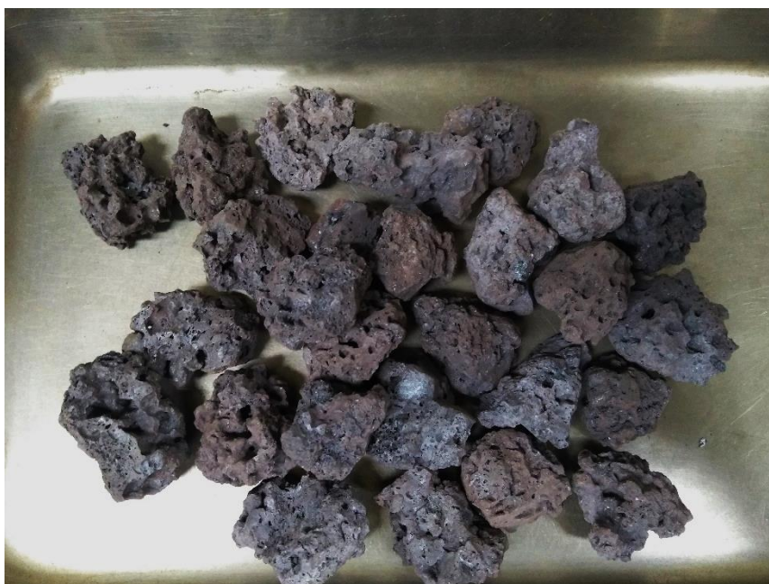
Figura 3.23 – Partículas de sinter de origem nacional
