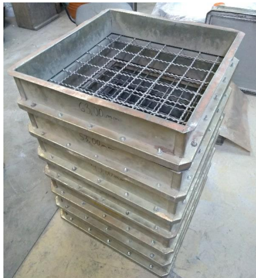
Figura 4.3. Peneiras utilizadas para análise granulométrica de sinter e coque.
