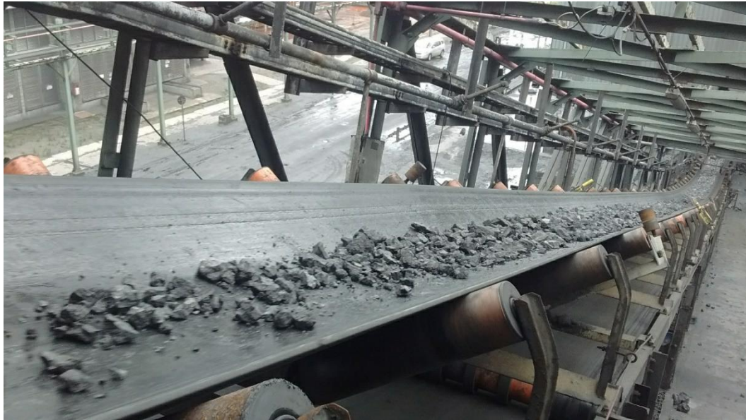
Figura 4.1 – Ponto de coleta das amostras de coque, no prédio de amostragem.
