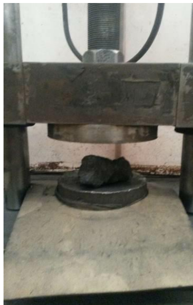
Figura 4.7 – Partícula de coque posicionada para um ensaio de queda de peso (Pires, 2016)
